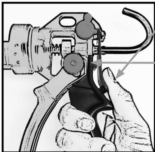
Entlastungsplatte betätigen, Stellrad drücken und Übersetzungsverhältnis 25:1 oder 12:1 durch Drehen wählen
