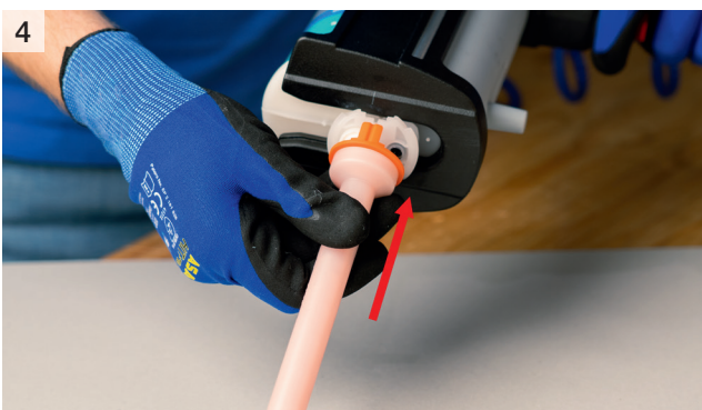
4 Materiaal afvegen en de statische menger plaatsen
