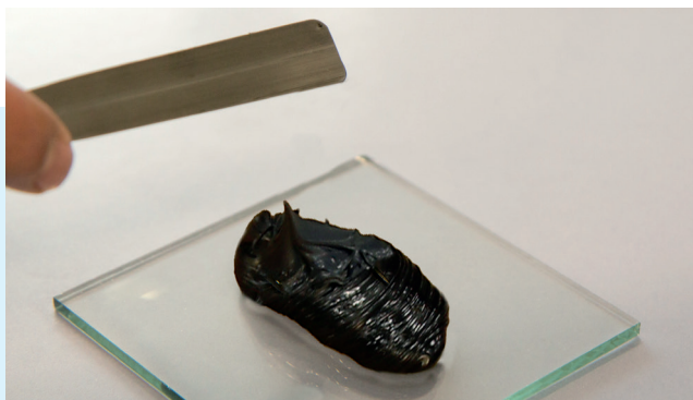
Consistentie „kauwgomachtig, de lijm „trekt terug“ – pottijd is bereikt
