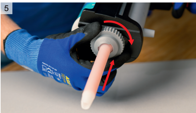
5 Bevestig de statische menger met de wartelmoer
