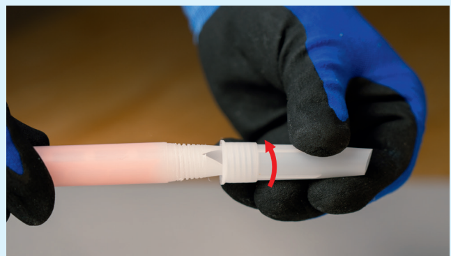
Schroef het standaardkokerspuitmond op de statische menger voor Blue-Line-kokers tot aan de aanslag
