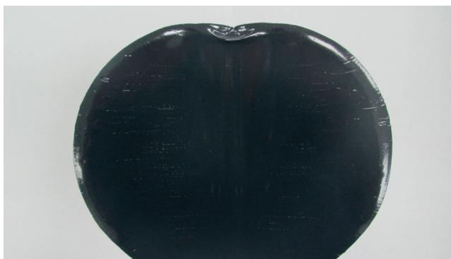
Mengpatroon bij verwerking via een meng- en doseersysteem
