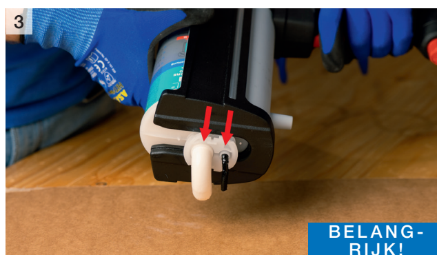
Materiaal zonder statische menger uitdrukken totdat er materiaal uit beiden openingen komt
