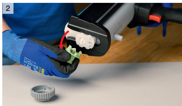
Draai de wartelmoer los en verwijder de plug
