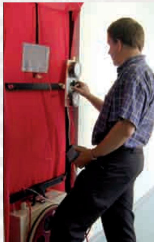
Blower-Door-Test zur Ermittlung der Luftdichtheit.
