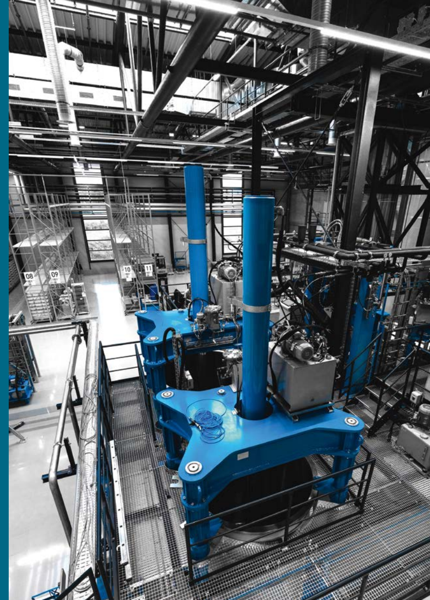
Hydraulikpressen sorgen für den notwendigen Druck in den Rohren der Produktionsstraße.
